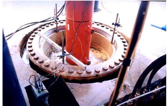
Fig. 8.- Sensores de desplazamiento
