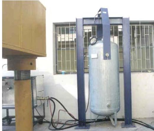
Fig. 9.- Sistema de medición cambio volumétrico
