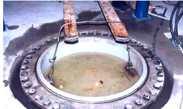
Fig. 3 Vista de cámara de ensayo y pistón de carga
