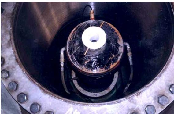
Fig.7.- Celda de carga
