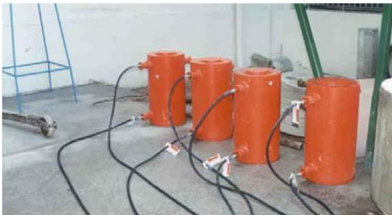
Fig.- 4 Gatos hidráulicos para carga axial
